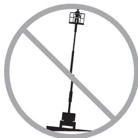
Não dependa do alarme de inclinação como um indicador de nível. O alarme de inclinação soará na plataforma somente quando a máquina estiver em declive acentuado.
