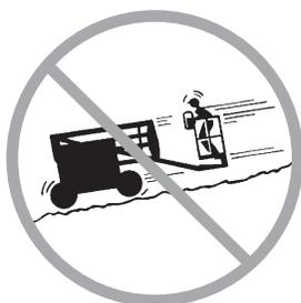
Limite a velocidade do percurso de acordo com as condições da superfície, de congestionamento, inclinação, localização de pessoas e quaisquer outros fatores que possam causar colisão.
