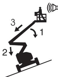
Se o alarme de inclinação soar com a plataforma em acentuação:
