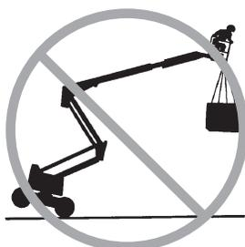
Não coloque nem prenda cargas fixas ou que sobressaiam de qualquer parte da máquina.
