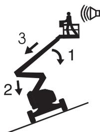
Se o alarme de inclinação soar com a plataforma em aclave:
