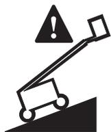
Se o alarme de inclinação soar quando a plataforma for elevada, a luz indicadora de máquina desnivelada se acenderá e a função de movimento em uma ou ambas as direções não operará. Identifique a condição da lança na inclinação, como mostrado a seguir. Siga as etapas para abaixar a lança antes de mover a máquina para uma superfície nivelada e firme. Não gire a lança durante o procedimento de abaixamento.
