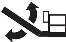
5 Lâmpada indicadora de sobrecarga da plataforma
