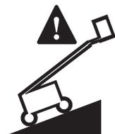
Se o alarme de inclinação soar quando a plataforma for elevada, a luz indicadora de máquina desnivelada se acenderá e a função de movimento em uma ou ambas as direções não operará. Identifique a condição da lança na inclinação, como mostrado a seguir. Siga as etapas para abaixar a lança antes de mover a máquina para uma superfície nivelada e firme. Não gire a lança durante o procedimento de abaixamento.
