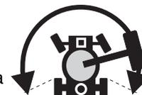
Observação: quando o sistema de habilitação de movimento estiver em uso, a máquina poderá movimentar-se no sentido oposto ao do movimento da alavanca de controle de movimento e direção.
