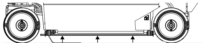
Plataforma completamente abaixada — Barras da proteção contra buracos elevadas
